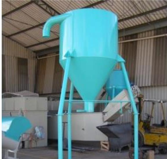
Figura 23 – Silo para armazenagem do produto acabado.
