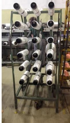
*Figura 17 - Bobinas de pontas*
