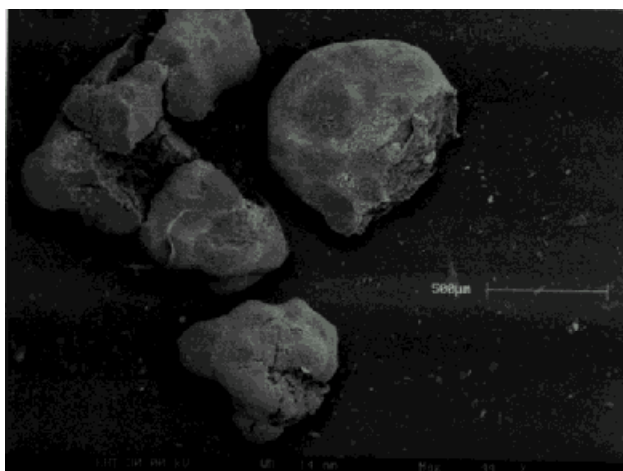
Fig. 3 - Grânulos anaeróbios observados por SEM.
