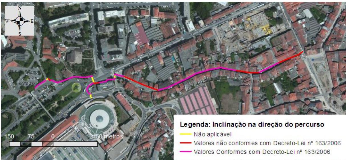
Figura 8.10 - Inclinação do piso na direção do percurso
