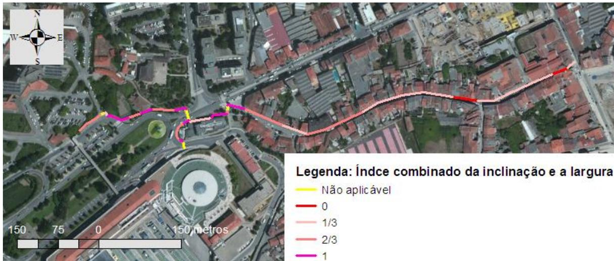
Figura 8.13 - Índice da combinação da inclinação com a largura dos passeios
