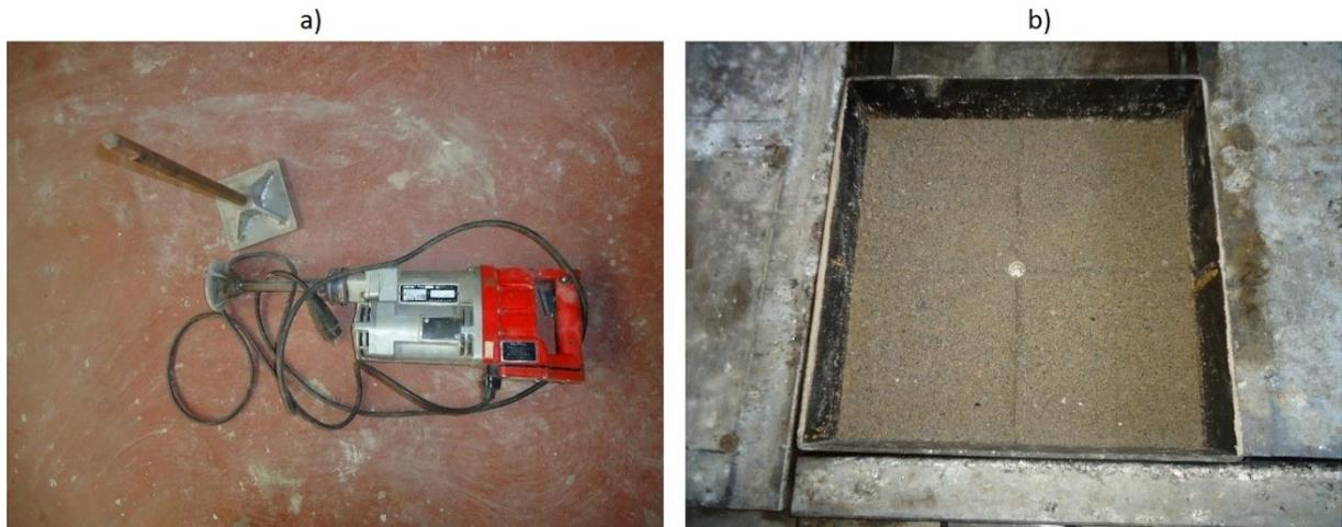
Figura 28: Compactação da camada granular: a) Martelo vibratório; b) Aspeto final
