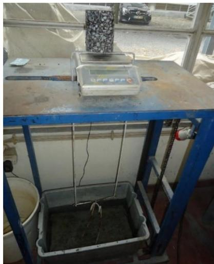
Figura 36: Mecanismo de determinação da baridade aparente
