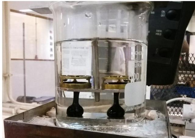
Figura 32: Ensaio de anel e bola
