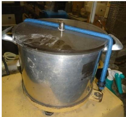
Figura 35: Picnómetro para determinação da BMT
