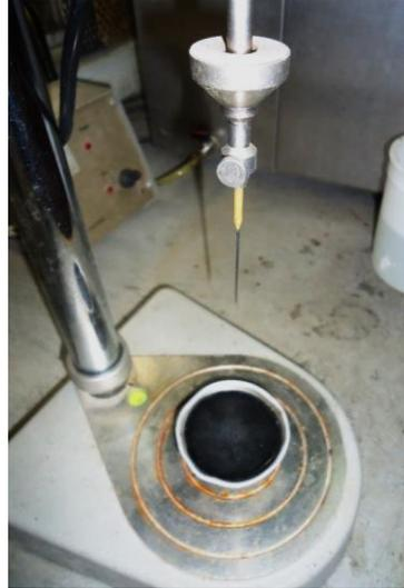
Figura 31: Ensaio de penetração
