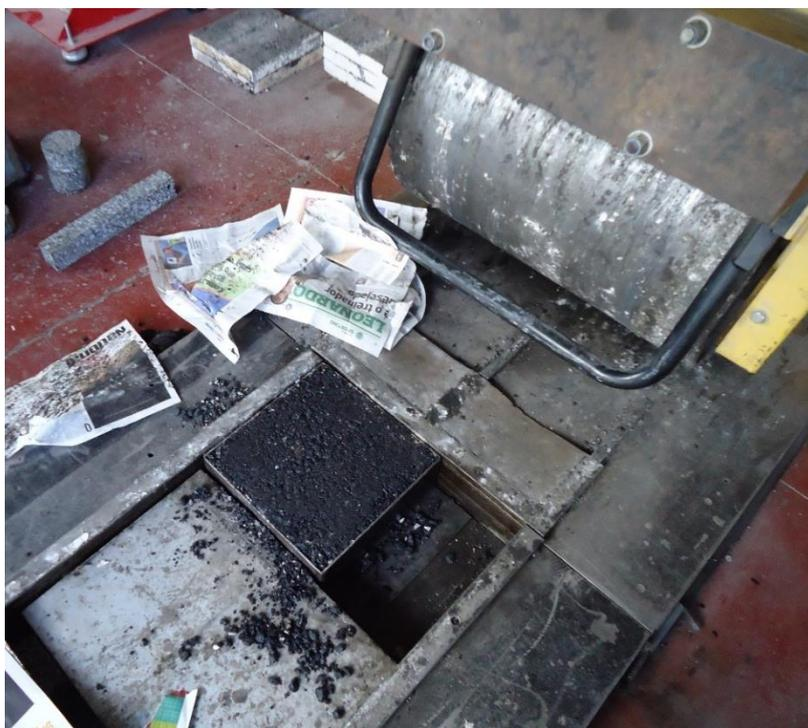
Figura 26: Compactação da mistura betuminosa na caixa metálica
