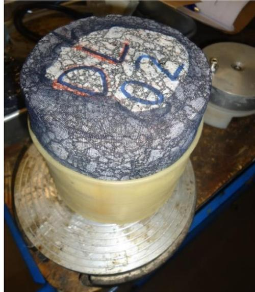
Figura 42: Aplicação de membrana dupla para confinamento do provete
