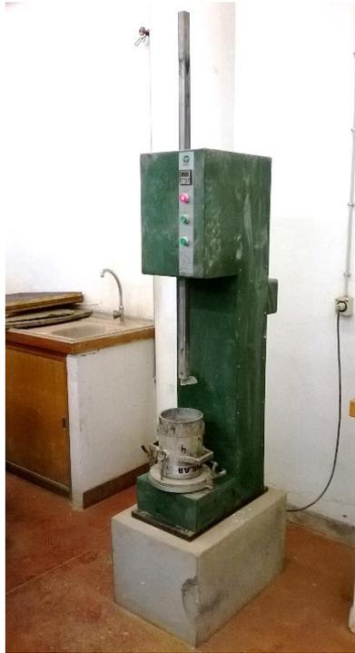
Figura 27: Compactador e cilindro de compactação Proctor
