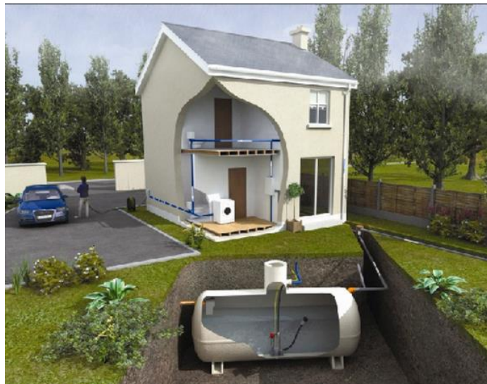
Figura 4 - Sistema de aproveitamento de água pluvial doméstico exterior e enterrado
