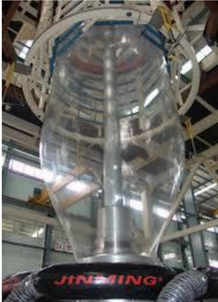
Figura 13 - Imagem do balão formado numa co-extrusora (blow film).
