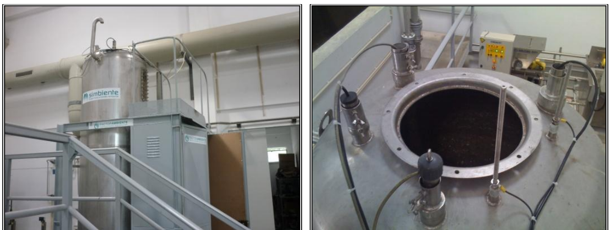
Figura 7. Instalação dos sensores no reator piloto
