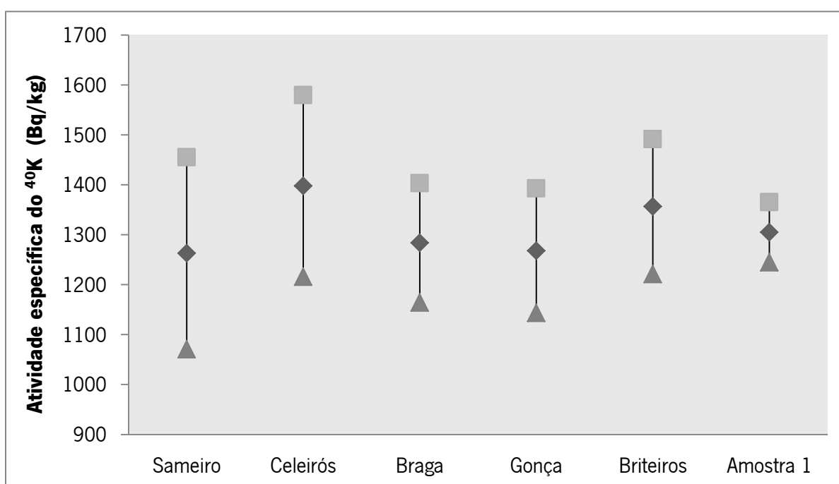
Figura 4-8 - Valores de atividade específica do ^{40}\text{K} , associada à variação da % \text{K}_2\text{O} , considerando os valores médios, mais ou menos dois desvios padrão, usando os fatores de conversão de teor ponderal, em %, para atividade específica do ^{40}\text{K} , em Bq/kg, presentes em IAEA (2003). Para a amostra 1, foram utilizados os valores de atividade específica do ^{40}\text{K} , mais ou menos o erro associado, em Bq/kg, obtidos através da técnica de espectrometria - \gamma .
