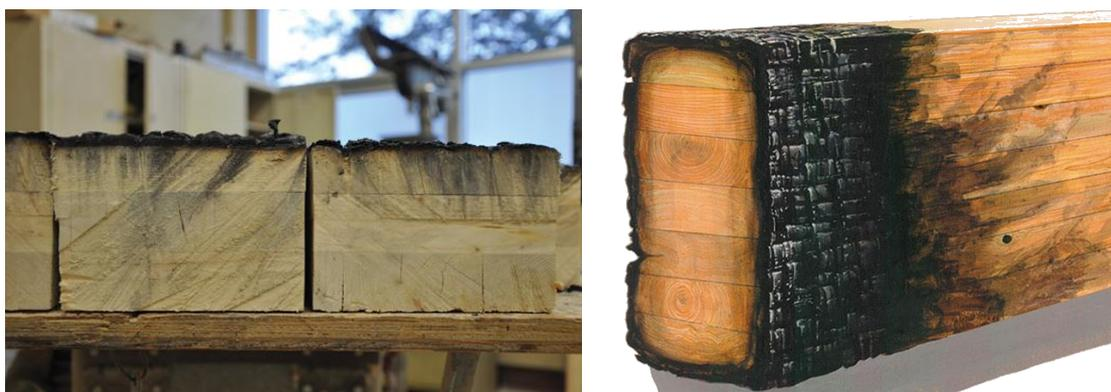
Imagem 40 – Peças de madeira submetidas a efeitos de incêndio <sup>36</sup>
