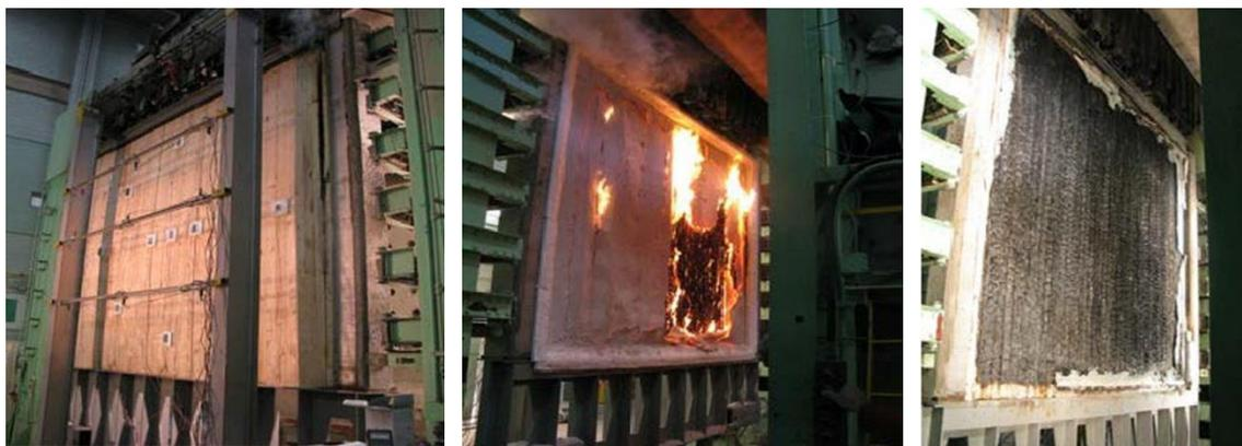
Imagem 42 – Teste à capacidade de resistir ao fogo dos painéis de MLCC <sup>40</sup>
