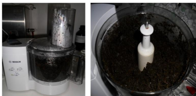
Figura 49 – Trituração da bodelha no Moinho de lâminas 2
