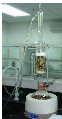
Figura 16 - Método de extração Soxhlet e representação [63]
