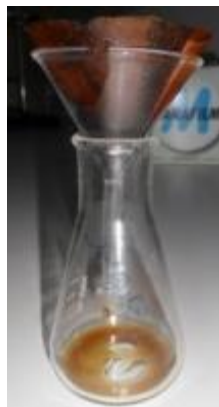
Figura 67 - Observação do óleo formado a partir do sargaço, triturado pelo moinho de lâminas 2, seco durante 8 dias na estufa, utilizando o hexano como solvente durante várias fases.
