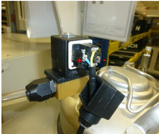
Figura 70 – Ligação elétrica da electroválvula
