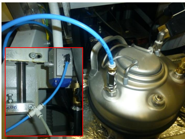
Figura 73 – Ligação pneumática entre o equipamento de coatig e o reservatório
