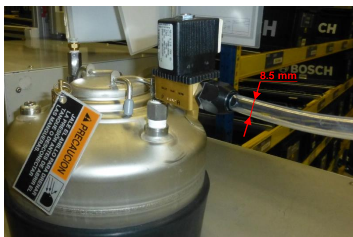
Figura 69 – Ligação do tubo de transporte de solvente à electroválvula
