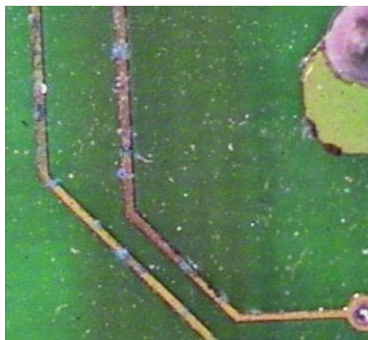
Figura 1 – Corrosão de circuitos de PCB [2]
