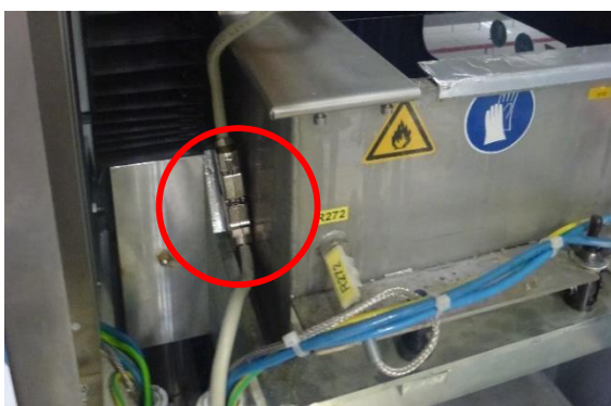
Figura 67 – Fichas de ligação rápida do sensor de viscosidade
