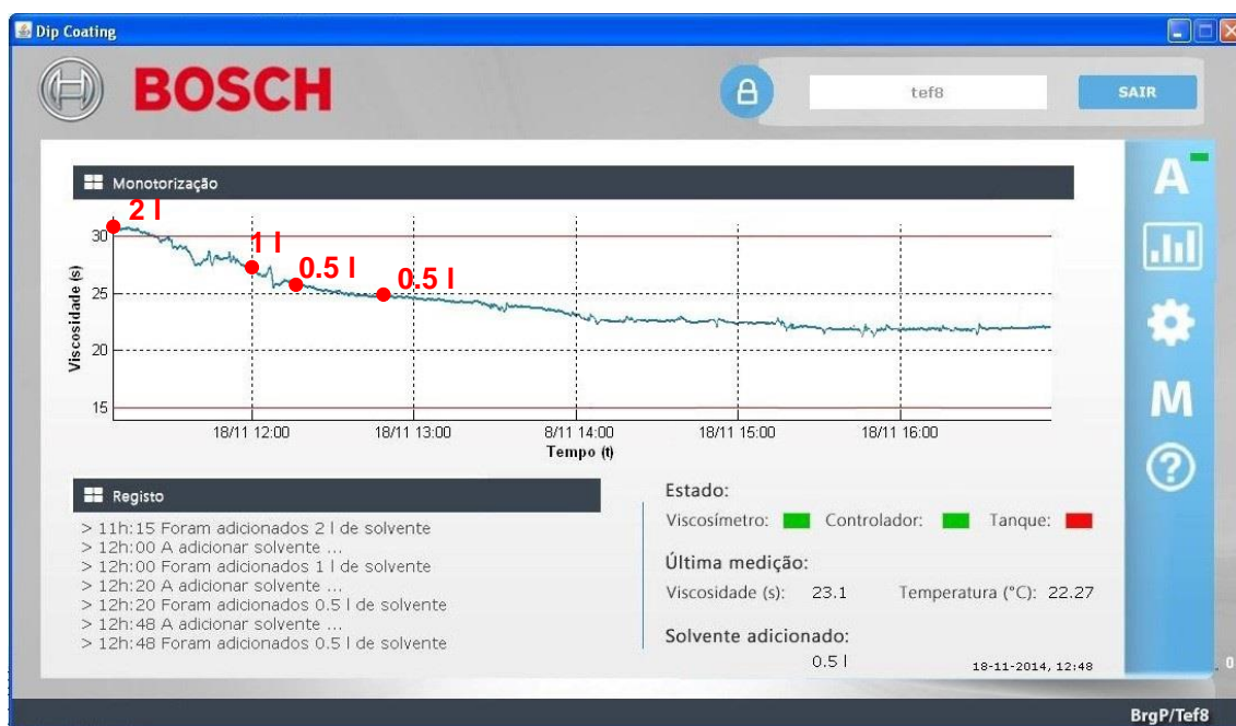
Figura 79 – Sistema de ajuste automático de viscosidade
