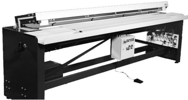
**Figura 2. 11 Equipamento de vulcanizar por resistência elétrica[13]**
