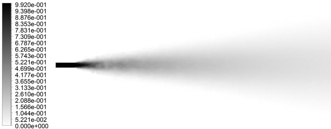
Figura 6.13 - Fração mássica de propano no plano de simetria do jato (Simulação 5.1.3 – (ii) propano)
