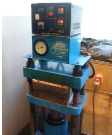
Figura 5.1: Prensa George & Moore Hidraulic Press SER n°H558/X utilizada para a preparação dos discos.
