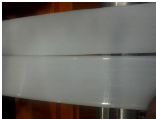
Figura 2.14: Acabamento superficial da fita produzida com recurso à calandra.
