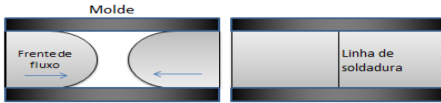
Figura 1.1: Esquemática da formação das linhas de soldadura durante o encontro das frentes de fluxo (Adaptado de [8]).
