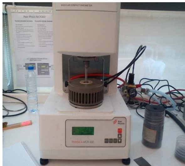
Figura 2.2: Reómetro utilizados nos ensaios em corte e em regime oscilatório
