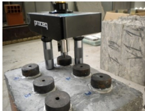
Figura 7. Realização dos ensaios de Pull-off com equipamento de arrancamento.
