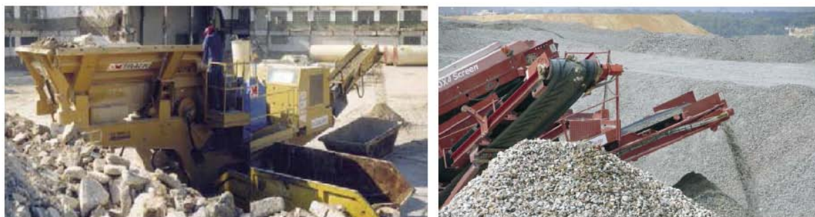
Figura 16 - Britagem dos RCD (extraído de Martinho e Gonçalves, 2008)
