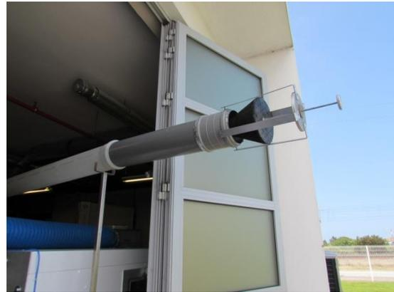
**Figura 5.12** – Ponto de extração com obstrução instalada
