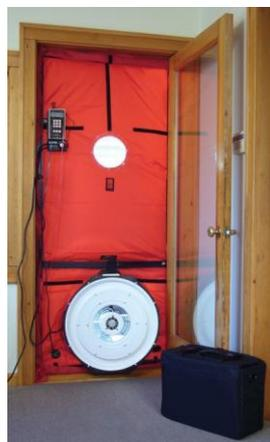
**Figura 2. 23** – Sistema *Blower Door Test* com porta ventiladora [3]
