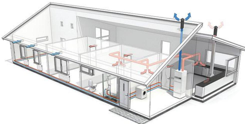
**Figura 2. 34** – Esquema do circuito de ventilação e bomba de calor [9]
