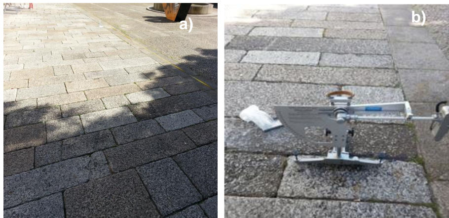
Figura 70 - a) Heterogeneidade das lajes que constituem o trecho e b) ensaio do pêndulo britânico
