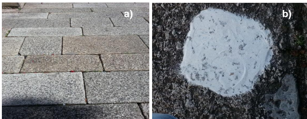
Figura 57 - a) Heterogeneidade na rugosidade das lajes de granito e b) Pormenor do ensaio de mancha de areia
