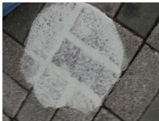
Figura 32 - Exemplo da aplicação do método de ensaio da “mancha de areia” num trecho
