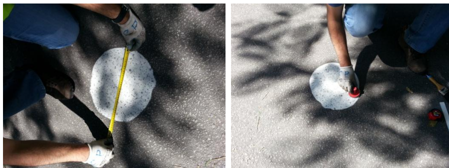
Figura 31 - Exemplo do método “mancha de areia”
