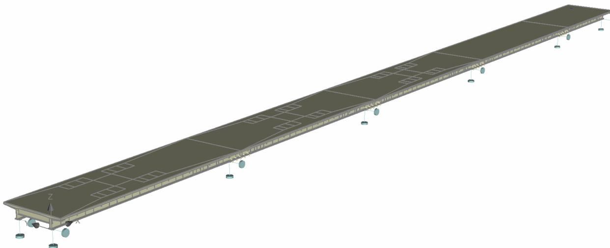
**Figura 4.16** – Modelo do tabuleiro do viaduto sobre o rio Sousa em ATENA<sup>®</sup> 3D.
