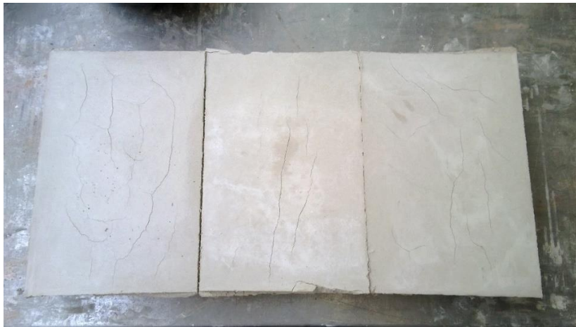
Figura 23: Argamassas fissuradas de cal hidráulica com 40% de PCM e 0,5% fibras.
