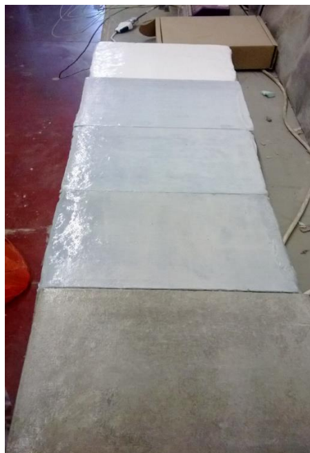
Figura 46: Diferença de opacidade entre o esmalte (no topo), vernizes com \text{TiO}_2 (ao centro) e verniz (em baixo).
