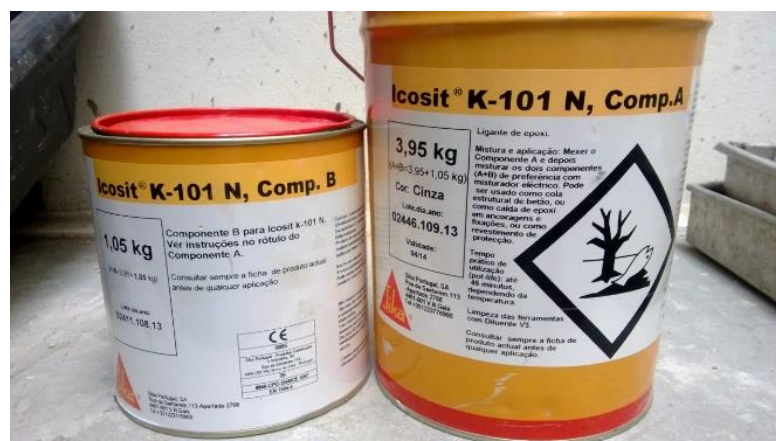
Figura 30: Latas dos componentes da cola epoxídica Icosit K-101 N da Sika.
