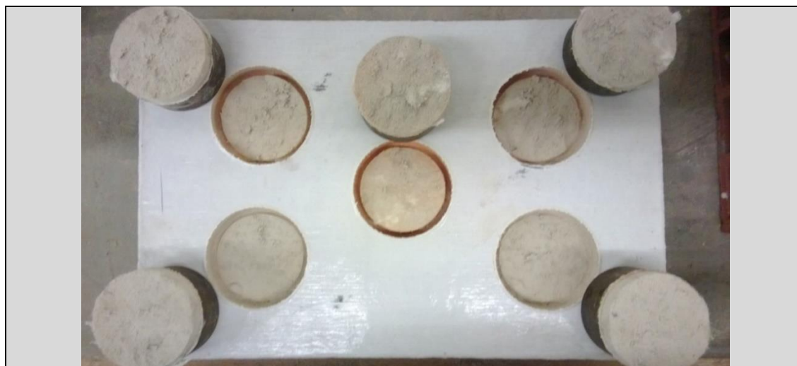
Quadro 29: Argamassa de cal hidráulica com 40% PCM e 1% fibras pintada com verniz 22% TiO 2 .
