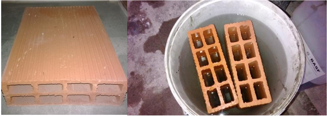
Figura 27: Tijolo cerâmico de formato normalizado (esquerda) e tijolos inseridos em água (direita).
