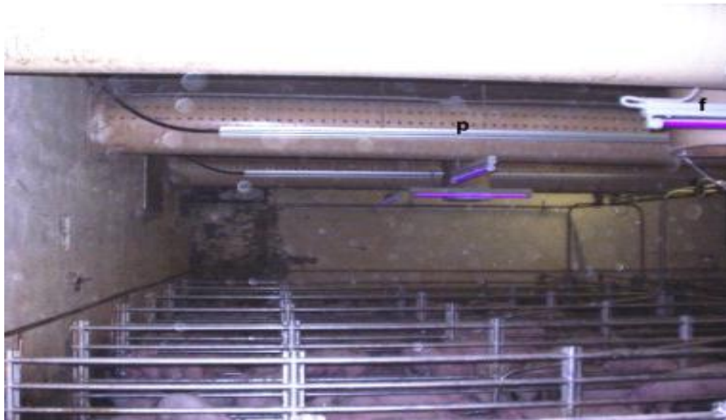
Figura 9: Uma das duas unidades de teste. Tubo perfurado (p) fornece ar fresco e o exaustor (f) remove o ar poluído para análise (Costa et al., 2012).
