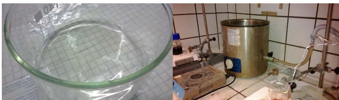
Figura 37: Lamínulas mergulhadas em álcool isopropílico (esquerda) e equipamento de banho de ultrassons (direita).
