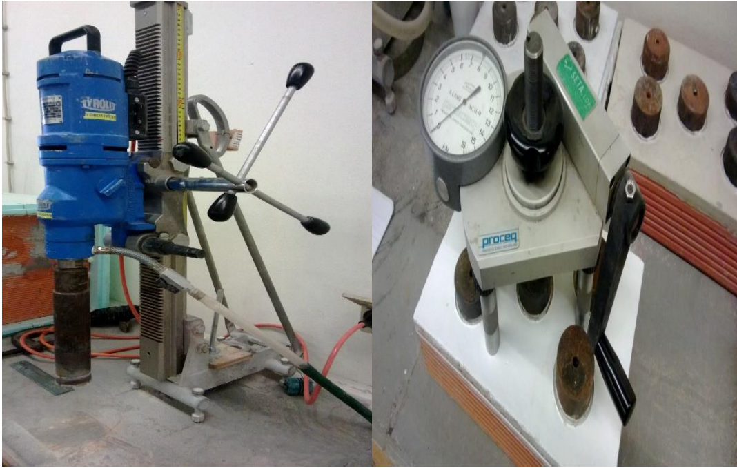
Figura 31: Máquina de perfuração elétrica (esquerda) e máquina manual de arrancamento por tração (direita).
