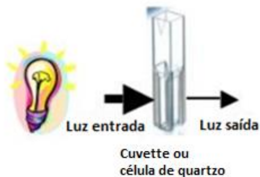
Figura 40: Esquema de funcionamento do ensaio de absorvância feito pelo espectrofotômetro (ScanSCI, 2013).
