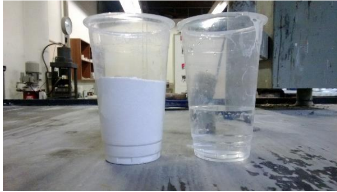
Figura 24: Quantidades de \text{TiO}_2 (esquerda) e água (direita) necessárias para produção da pasta de titânia.
