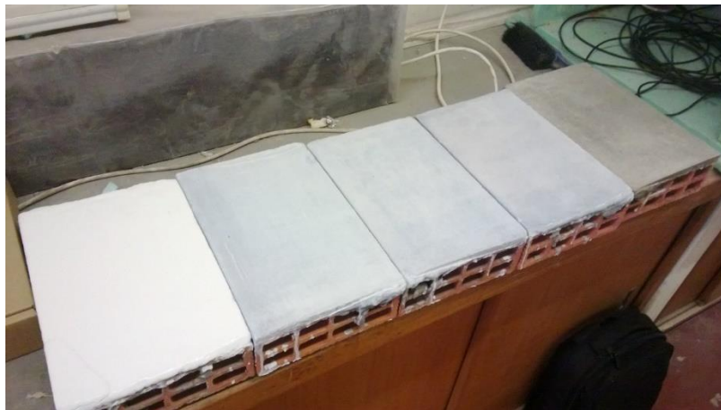
Figura 45: Diferença de tonalidades entre o esmalte (à esquerda), vernizes com \text{TiO}_2 (ao centro) e verniz (à direita).
