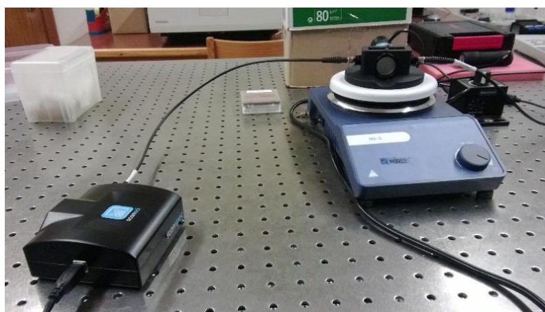
Figura 41: Espectrofotômetro UV/Vis preparado para ensaios de absorvância da marca ScanSCI apoiado num agitador magnético.
