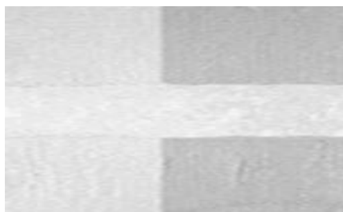
Figura 7: Tinta nanocompósita (esquerda) e tinta de referência (direita) após quatro semanas de acumulação de sujidade, sendo que a parte central não esteve exposta à sujidade (Carneiro et al., 2012).
