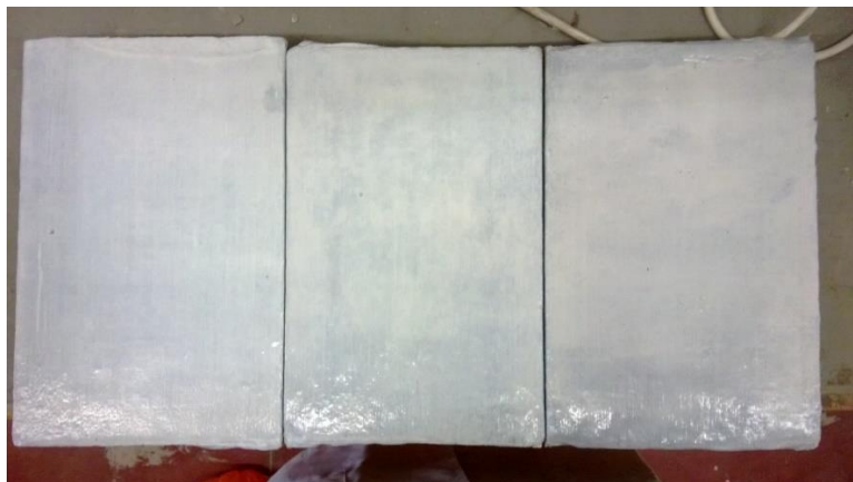
Figura 47: Verniz 33% (esquerda), verniz 22% (centro) e verniz 11% (direita).
