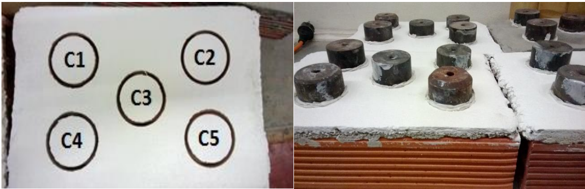
Figura 32: Disposição das cinco amostras de C1 a C5 (esquerda) e colagem dos discos de metal (direita).
