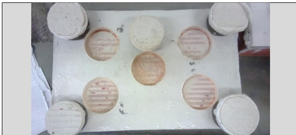
Quadro 22: Argamassa de gesso com 40% PCM e 1% fibras pintada com verniz 11% TiO 2 .
