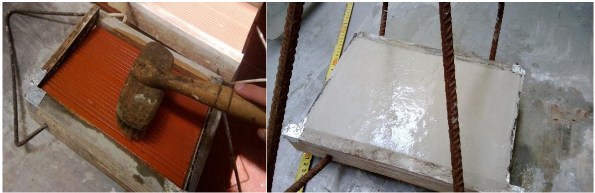
Figura 28: Sistema de cofragem em volta do tijolo com 1 cm de altura.
