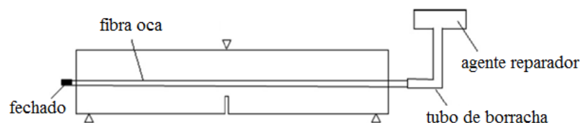
Figura 4 – Diagrama esquemático do sistema de abastecimento externo contendo o agente de reparação, baseado na descrição de Mishashi e Joseph (Wu et al., 2012)
