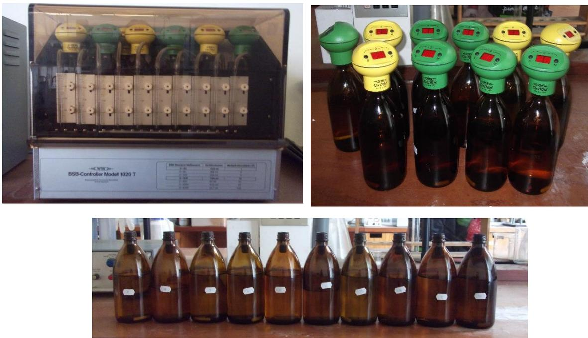
Figura 3.21.a – Determinação da CBO através do método oxitop
