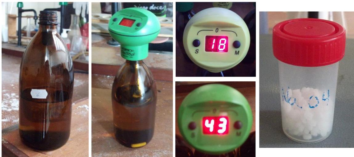
Figura 3.21.b – Determinação da CBO através do método oxitop
