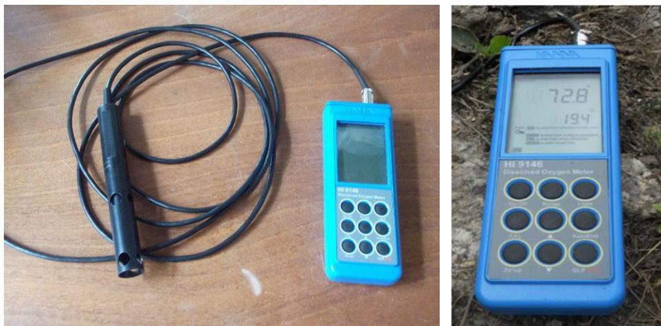
Figura 3.19 – Equipamento de medição da concentração do OD in situ
