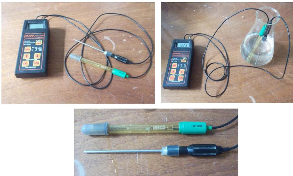
Figura 3.20 – Equipamento de medição do pH e temperatura, in situ
