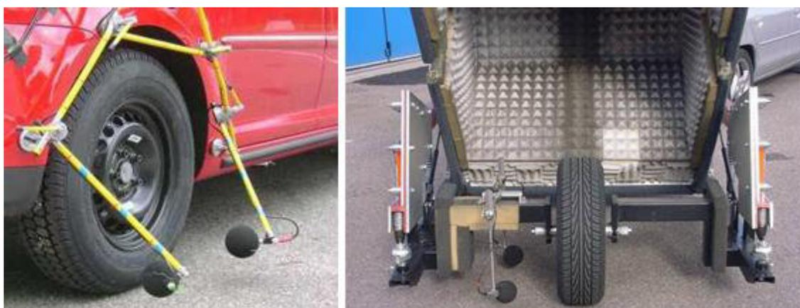
Figura 10 – Sistemas de aquisição da metodologia CPX (Loon, 2008)
