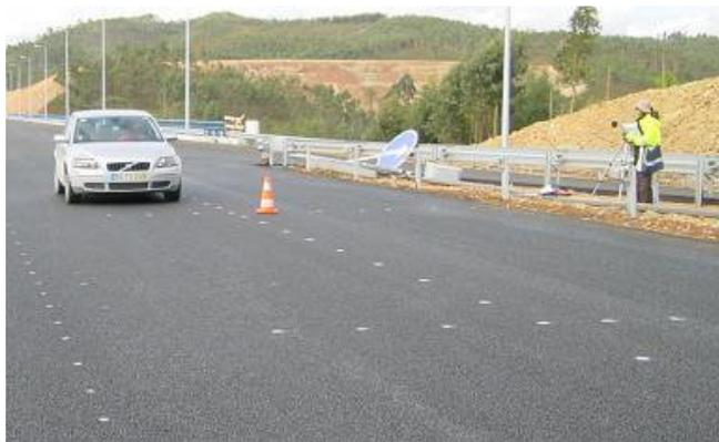
Figura 9 – Configuração da metodologia de aquisição de ruído pelo método SPB (Freitas et al., 2008c)
