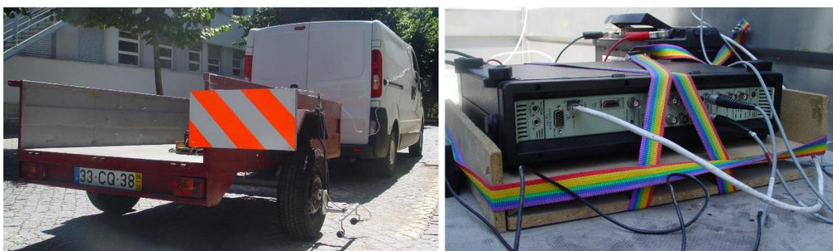
Figura 27 – Carrinha e atrelado com todo o esquema de montagem dos microfones e da plataforma Pulse
