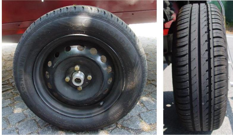
Figura 25 – Pneu ContiEcoContact3 195/65-R15
