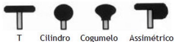
Figura 3.12 - Exemplos de terminações de barreiras, adaptado de [26]
