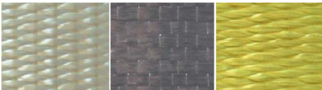
Figura 3 – Tipos de fibras, a) Fibra de Vidro, b) Fibra de Carbono, c) Fibra de Aramida [24]
