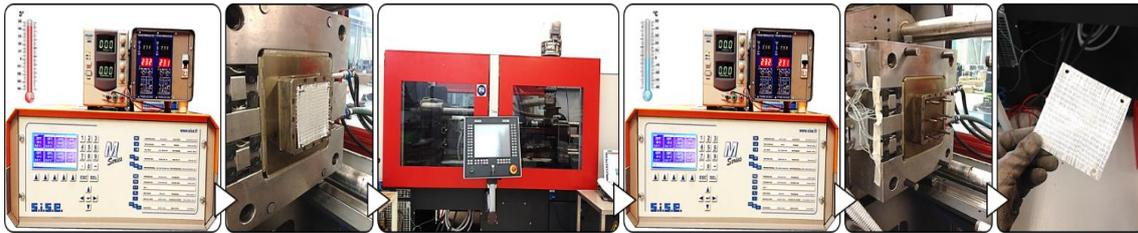
Figura 18 – Etapas do procedimento experimental do processo moldação por injeção
