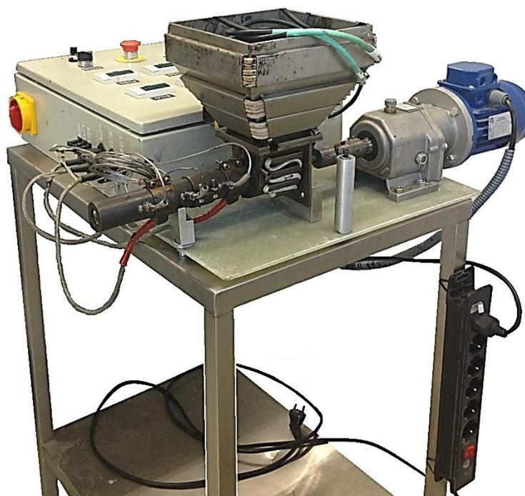
Figura 11 – Microextrusora e unidade de controlo utilizada
