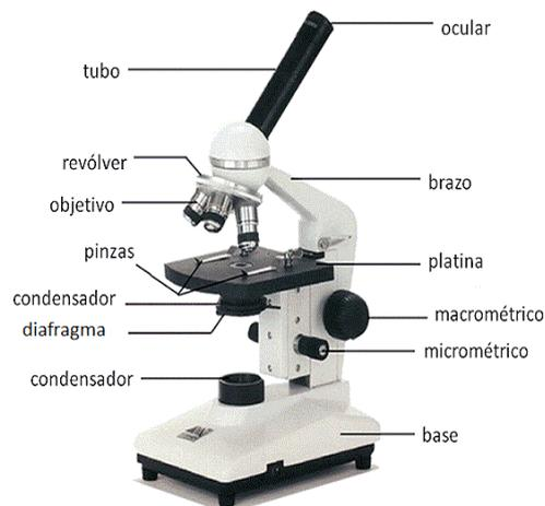
Figura 25 – Microscópio ótico
