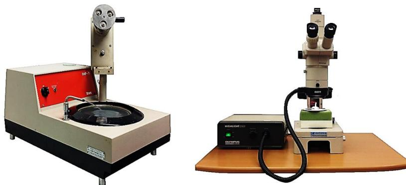
Figura 27 – Máquina de polimento Struers DAP-7 e lupa Olympus SZ4045TR
