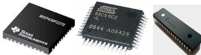
Figura 4-9-Imagem dos três microcontroladores selecionados: a) Msp430F2370 [14], b) AT89C51IC2 [25], c) PIC18F4550 [13]
