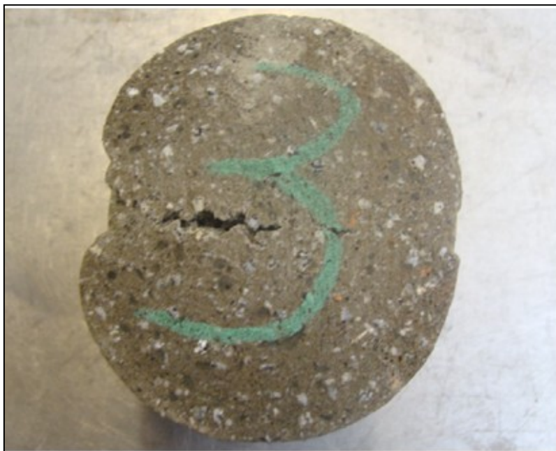
Figura 21- Aspeto dos provetes da amassadura M durante o ensaio de resistência à tração.
