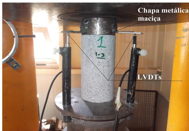
Figura 4.3: Esquema de medição das deformações do provete ao longo do ensaio de compressão uniaxial
