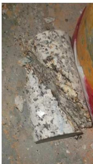
Figura 4.4: Processo de fratura à compressão do granito amarelo de Guimarães
