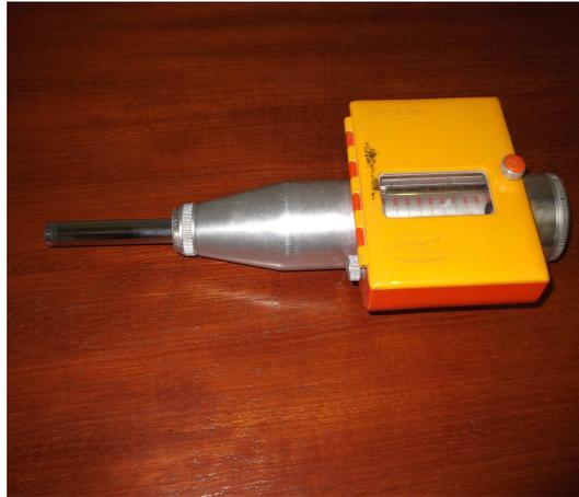
Figura 3.8: Esclerómetro tipo NR
