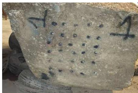
Figura 3.15: Granito amarelo de Guimarães não retificado com face visivelmente degradada
