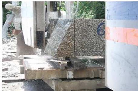
Figura 3.17: Retificação dos blocos de granitos
