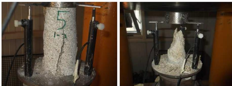
(a) Rotura dúctil característica dos provetes na direção 1\_3 (b) Rotura frágil característica dos provetes nas direções 2\_4 e 5\_6
