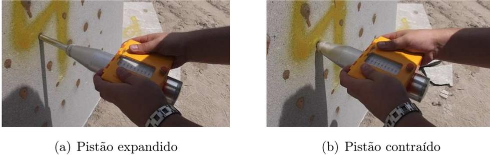
Figura 3.22: Equipamento e operação do MS
