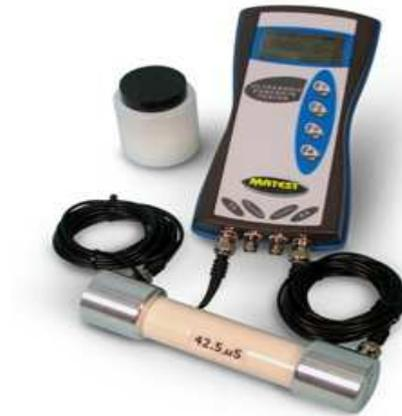
Figura 3.6: Aparelho de ultrassons utilizado nos ensaios da casa de Guimarães (MATEST)
