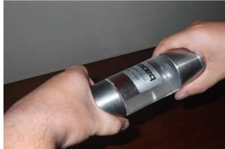
Figura 3.20: Calibração do *Pundit Lab* por meio de uma barra com tempo de propagação conhecido
