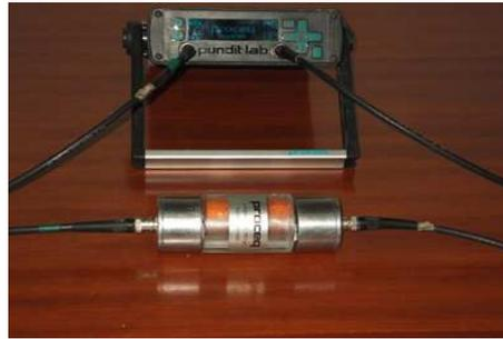
Figura 3.19: Aparelho de ultrassons utilizado nos ensaios em blocos de granito
