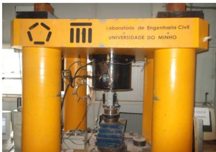
Figura 4.2: Pórtico utilizado no ensaio de compressão uniaxial
