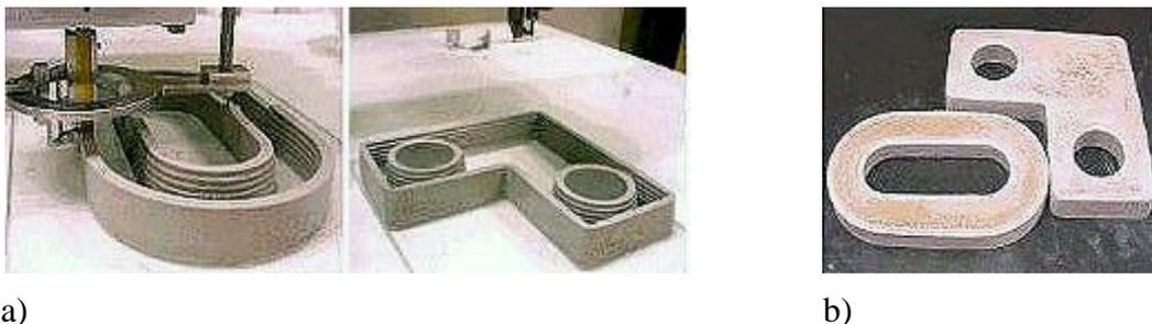
Figura 2.4 – Faseamento da técnica “Contour crafting”: a) Fase 1 - criação limites exteriores; e b) Fase 2 - preenchimento do elemento (Khoshnevis, 2004)
