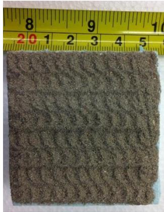
Figura 4.2 – Deposição de uma camada de mistura seca sobre peça de apoio
