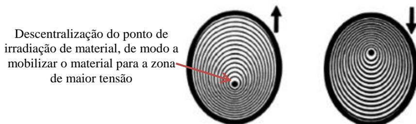
Descentralização do ponto de irradiação de material, de modo a mobilizar o material para a zona de maior tensão
