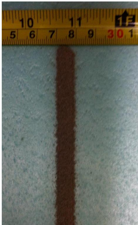
Figura 4.3 – Largura de espalhamento da mistura depositada
