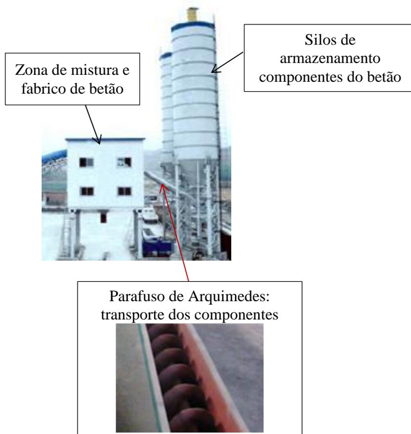
Figura 3.18 – Central de betão: destaque para o transporte dos componentes através do parafuso de Arquimedes (Sousa Coutinho, 1966)
