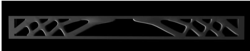
Figura 2.31 – Viga otimizada construída a escala reduzida (Sondergaard, 2009)
