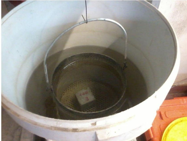
Figura 19- Pesagem da massa hidrostática do provete saturado, expressa em gramas.
