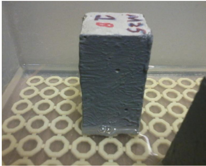
Figura 17- Recipiente onde se efetuou a Absorção capilar.
