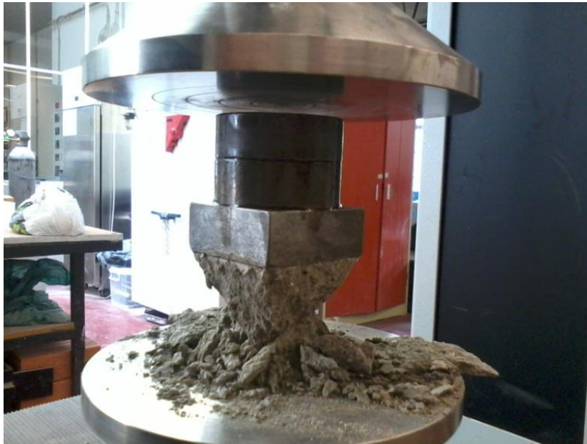
Figura 16- Ensaio à compressão
