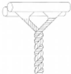
Figura 5 – Formação de um fio “twist-spin”
