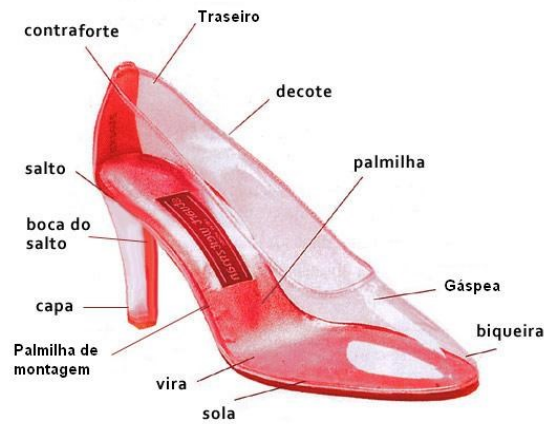
Figura 23: Elementos de um calçado feminino. (Fonte: CTCCA, 1997)
