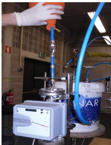
Figura 60 - Teste do balão no caudalímetro (volume medido).
