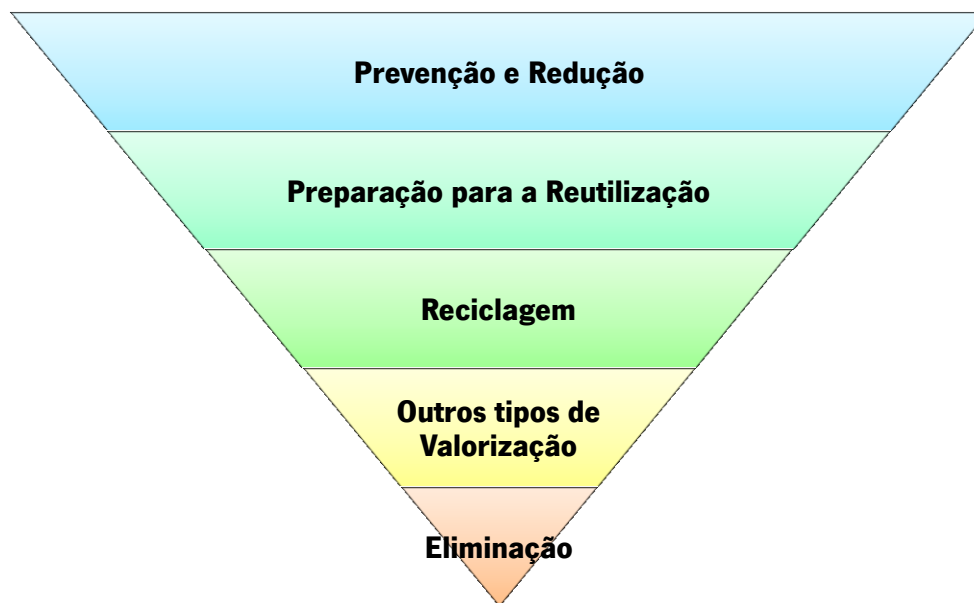
Figura 3 - Hierarquia das operações de gestão dos resíduos. Adaptação de (Ferrão, et al., 2011).
