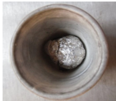
Figura 71 – Alumínio prensado no interior do cadinho.
