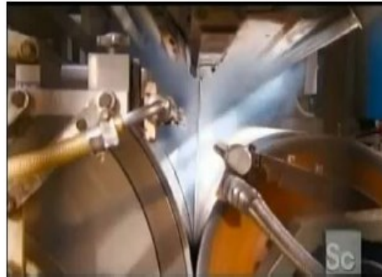
Figura 17 – Aspergimento de plástico líquido entre o rolo de alumínio e o papel (Tetra Pak Containers).
