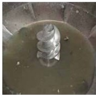
Figura 37 – Rotor helicoidal de média consistência (Zuben, et al.).
