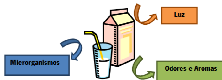
Figura 15 – Barreira física, função do alumínio, essencial para as ECAL.
