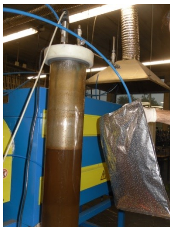
Figura 62 – Recolha de gases de síntese na coluna de água
