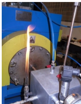
Figura 58 – Teste da chama realizado na caixa intermédia de recolha.
