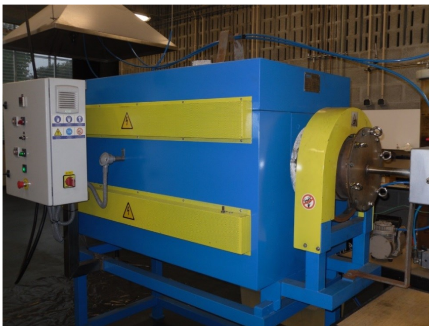
Figura 90 – Forno rotativo utilizado nos teste de pirólise (CVR, 2013).
