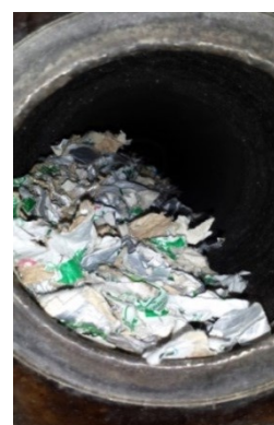
Figura 56 – Embalagens triturados no interior do forno.
