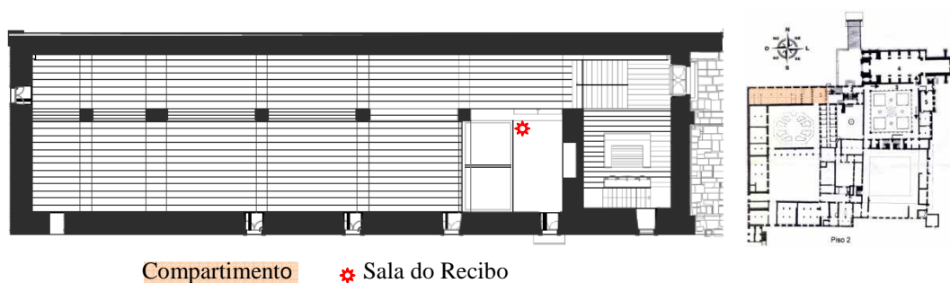
Figura 3.14 Planta parcial do piso 2 com indicação do posicionamento do equipamento de medição na Sala do Recibo ou Sala de Exposições, Mosteiro de Tibães (TIBÃES, 2013)
