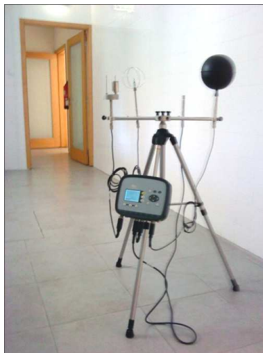
Figura 3.18 Equipamento de medição e de registo de parâmetros ambientais
