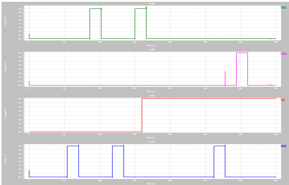
Figura 4.70 Simulação global II – resultados obtidos para as saídas da máquina Up (verde), Dw (cor-de-rosa) e Sw (azul) e valor simulado da variável I (vermelho).
