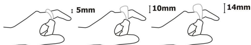
Figura 38. Altura do anel. Padrão joalheria brasileira. Fonte Costa (2008)
