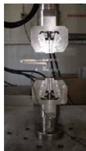
Fig. 8: Configuração do ensaio de tração
