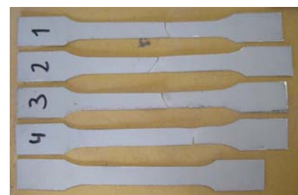
Fig. 9: Provetes testados após rotura
