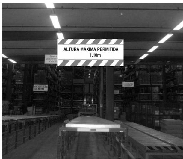
Figura 56 - Delimitador de Altura para os Tapetes de Rolos Laterais
