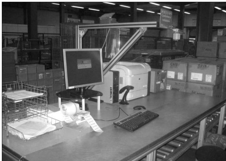
**Figura 55 - Posto de Trabalho 9 para Processamento de Material Volumoso**
