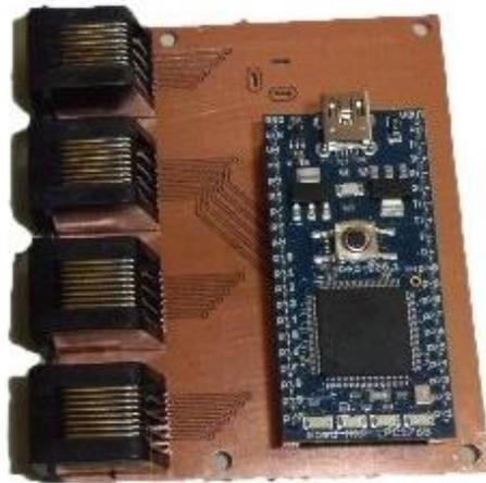
**Figura 25.** Primeiro protótipo com solução MBED
