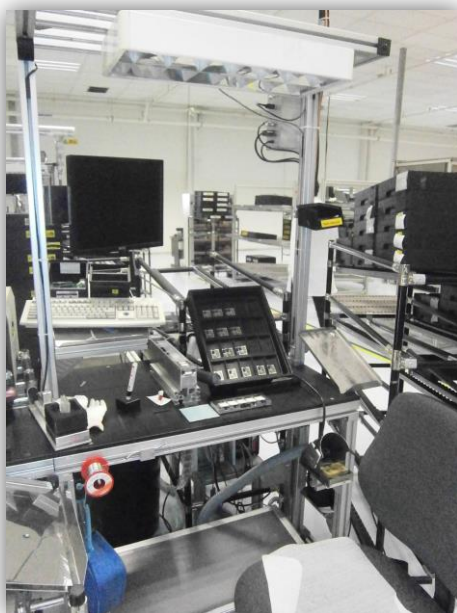
Figura 40 – Posto de pré-montagem
