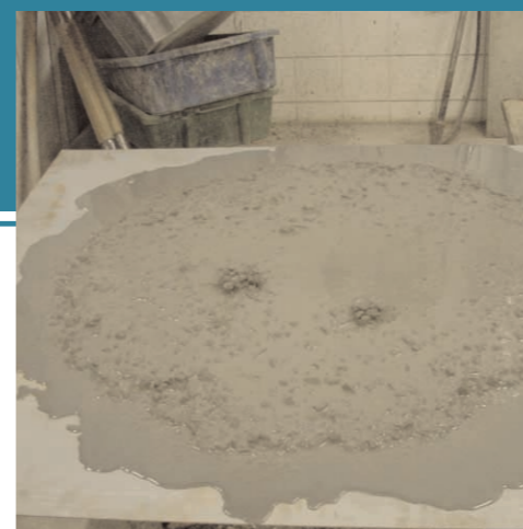
Fig. 10 - Amostra de betão depois de espalhada com o cone de Abrams
