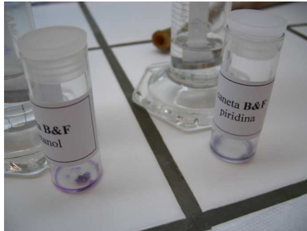
Figura 2.19 | Extração da tinta do papel usando piridina como solvente
