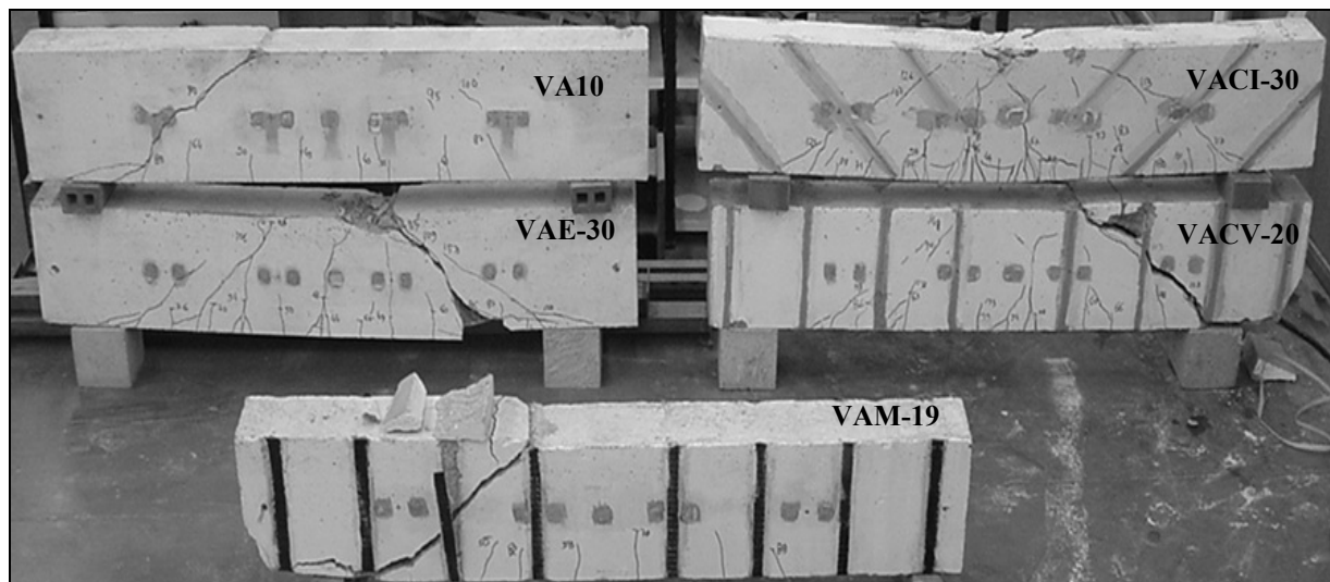
Figura 10 - Modos de rotura verificados nas vigas com 4 \phi 10 longitudinais.
