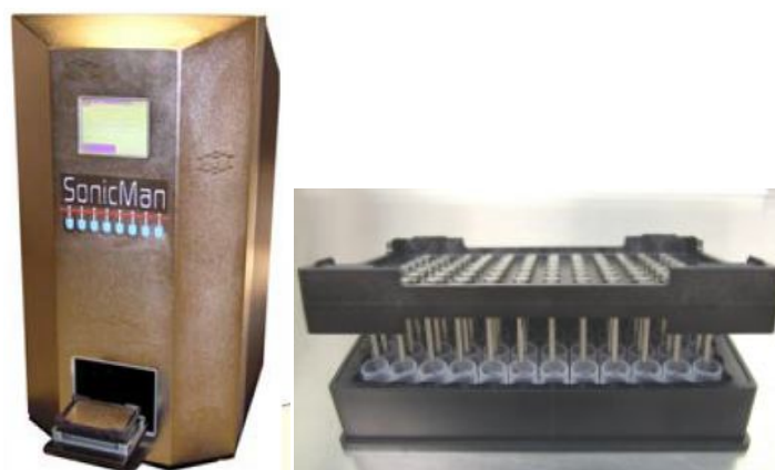
Figura 1.8 Na esquerda é apresentado o equipamento SonicMan™ da MatriCal enquanto na direita se encontra a tampa descartável utilizada neste sistema [28, 29].
