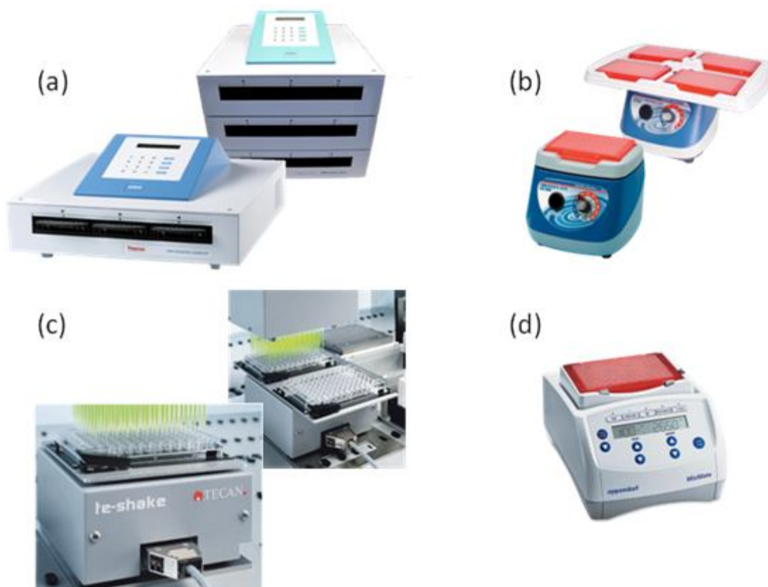
Figura 1.9 Soluções apresentadas por várias empresas para a mistura na microplaca, baseadas na agitação orbital/vortex da microplaca: (a) iEMS Microplate Incubator/Shaker HT da Thermo Scientific [30]; (b) Microplate e Multi-microplate Genie® da Scientific industries [31]; (c) Te-Shake TM da TECAN [32]; (d) MixMate® da Eppendorf . [33].
