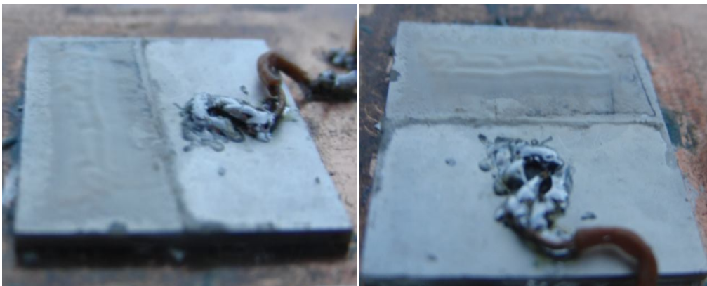
Figura 4.23 Diferentes perspetivas da camada de adaptação mecânica depositada por sputtering . Esta é composta por SU-8 com Titanato de Bário.
