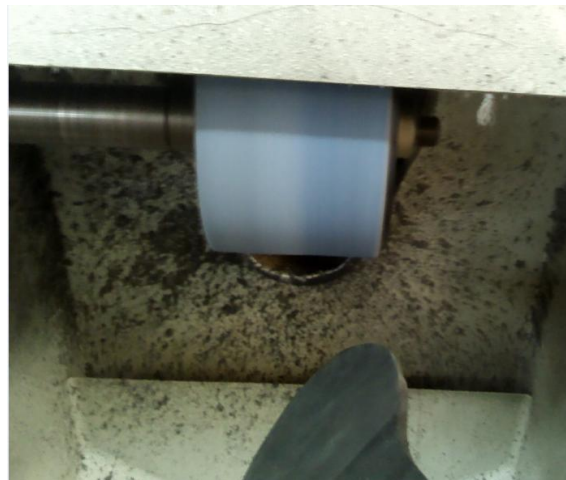
Figura 34 – Remoção de arestas e acerto de solas
