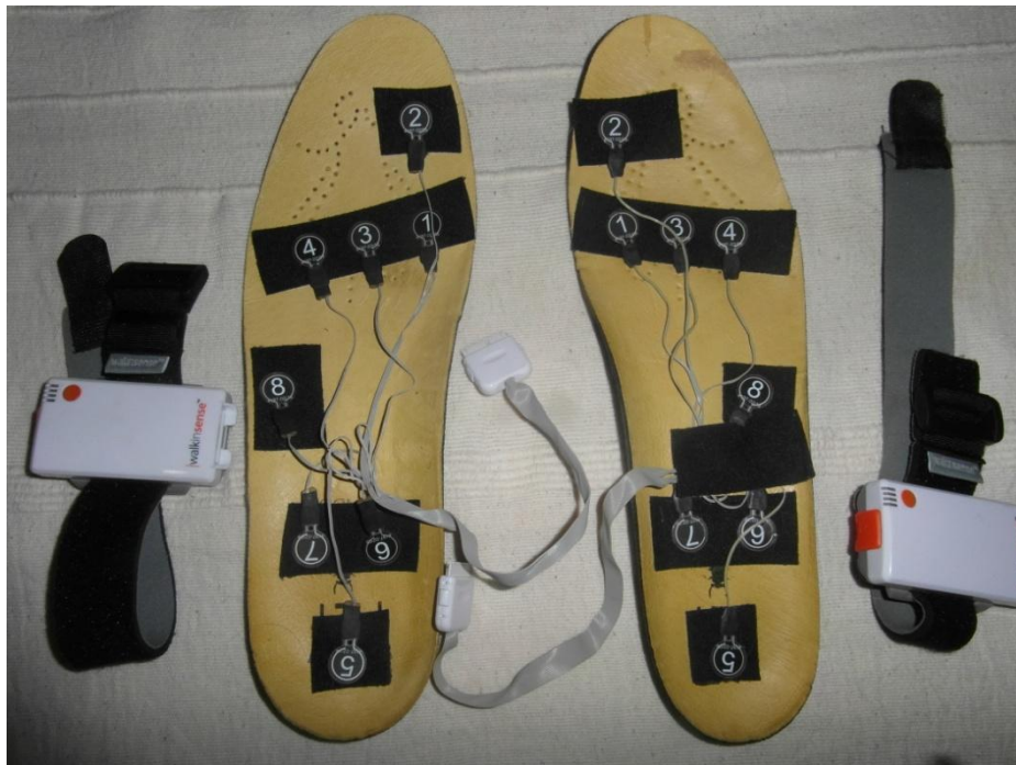
Figura 22 – Palmilhas com rede de sensores afixados e dispositivos
