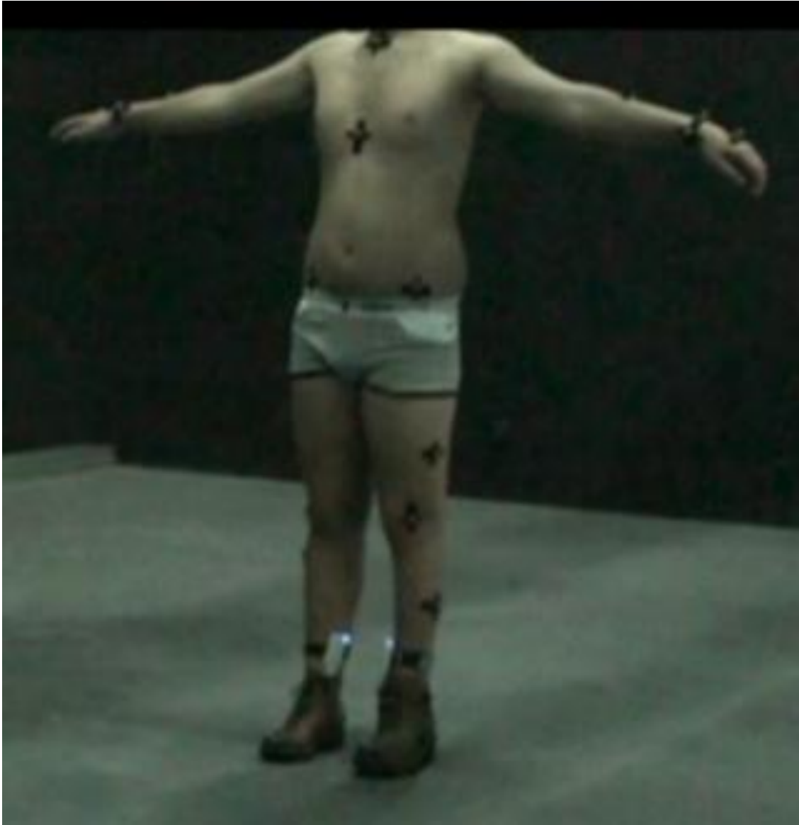
Figura 14 – Visualização dos marcadores acoplados no corpo e dispositivos walkinSense
