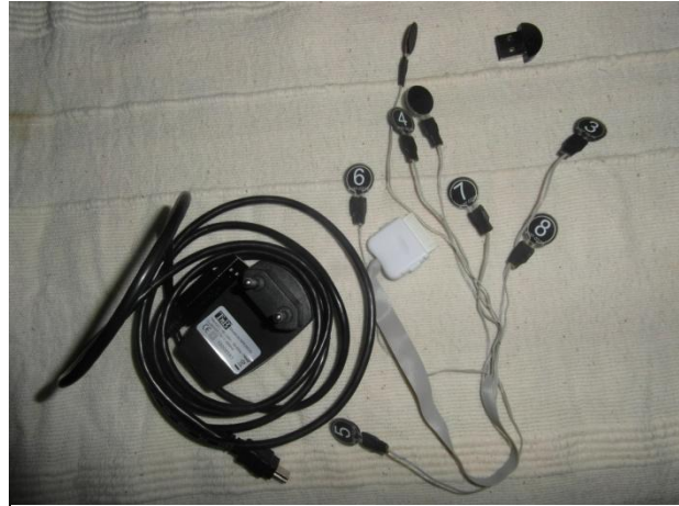
Figura 21 – Rede de sensores, cabo USB com carregador e pen bluetooth
