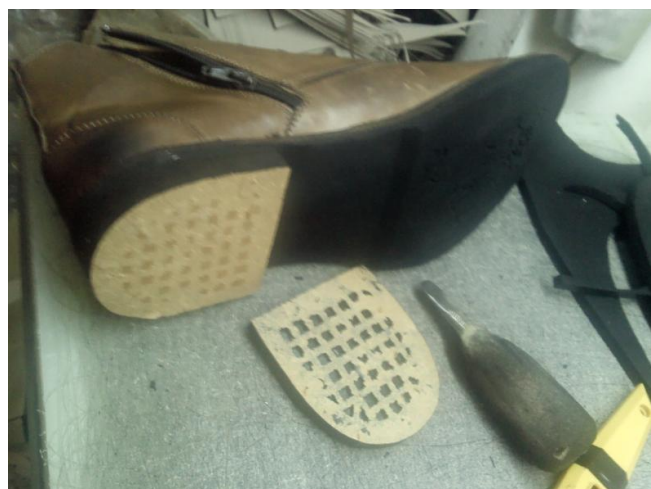
Figura 31 – Remoção do tacão
