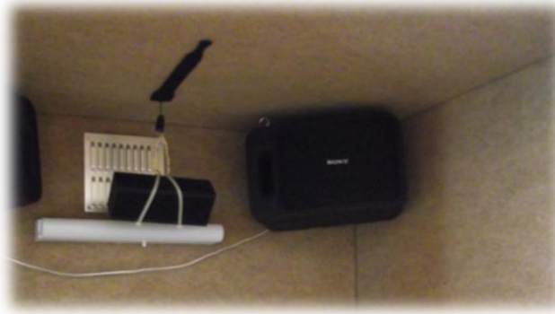
Figura V.12 – Coluna sem fios Jawbone Jambox suspensa no teto da cabine audiométrica.
