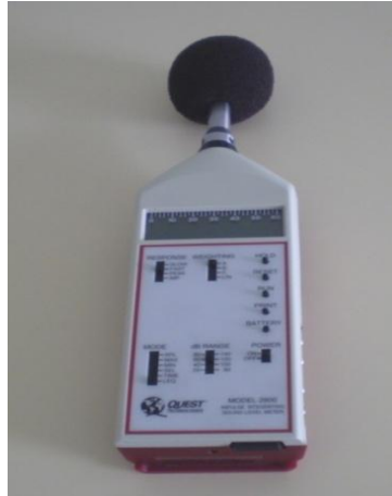
Figura I.6 – Exemplo de um aparelho para medir o ruído: Sonómetro.
