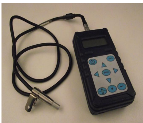
Figura I.5 – Exemplo de um aparelho para medir o ruído: Dosímetro.
