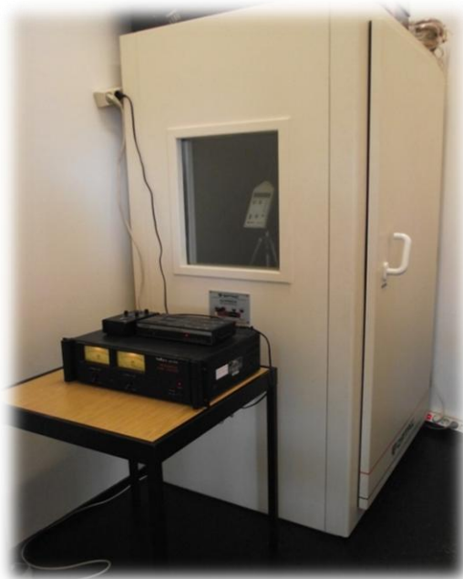
Figura V.7 – Equipamento instalado para ajustar a intensidade sonora do ruído de fundo.
