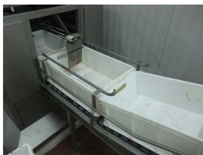
Fig. 3. 26 - Forma correta de inserir caixas no elevador.
