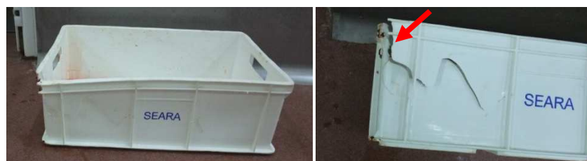
Fig. 3. 27 - Exemplos de caixas partidas que devem ser rejeitadas.
