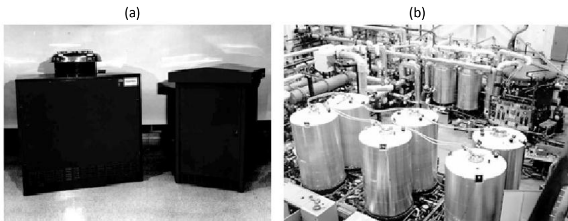
Figura 2.9 (a) A FC PC-11 12.5-KW foi desenvolvida para aplicações residenciais durante o programa TARGET. A união do contentor esquerdo, que contém a FC e o reformador do gás natural com a unidade direita que tem o inversor, permite criar a corrente elétrica. ( UTC Fuel Cells.). (b) O PC-19 1-MW, com FC de ácido fosfórico contido nos reservatórios. O carbono é usado com suporte da catálise, reduzindo desta forma a utilização da platina ( UTC Fuel Cells.)
