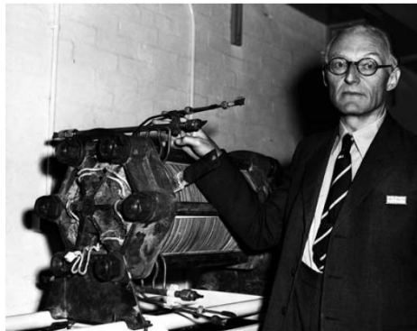
Figura 2.6 Bacon com FC de 6-KW , apresentada em 1959. (Copyright Hulton-Deutsch Collection/Corbis.)© 2003
