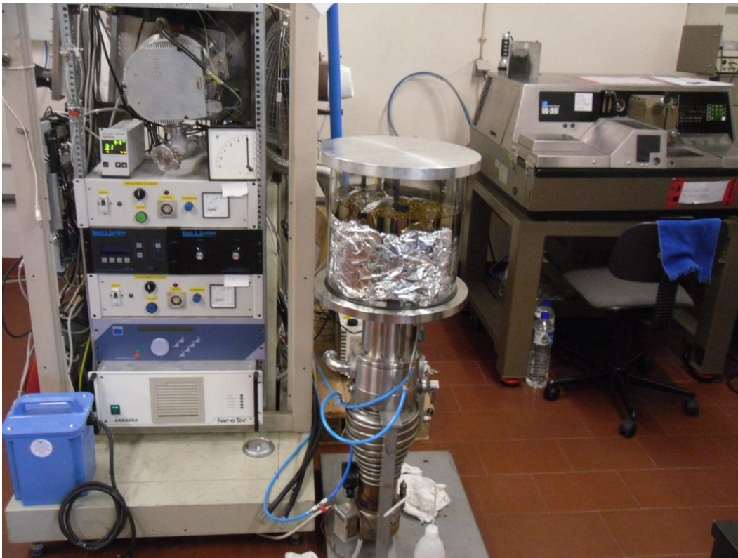
Figura 6.17 Câmara de evaporação térmica usada para a deposição do ouro.
