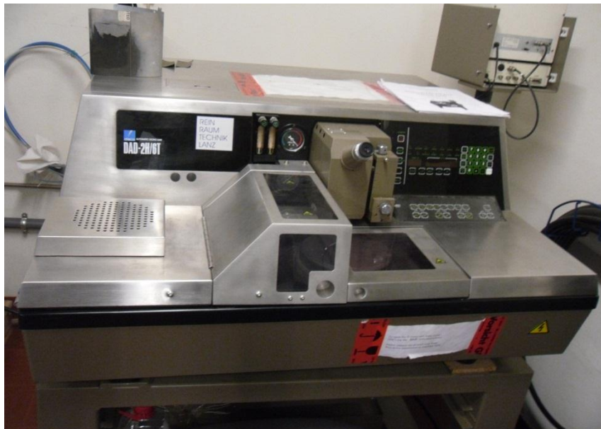
Figura 6.7 O equipamento utilizado para efetuar a abertura dos canais.
