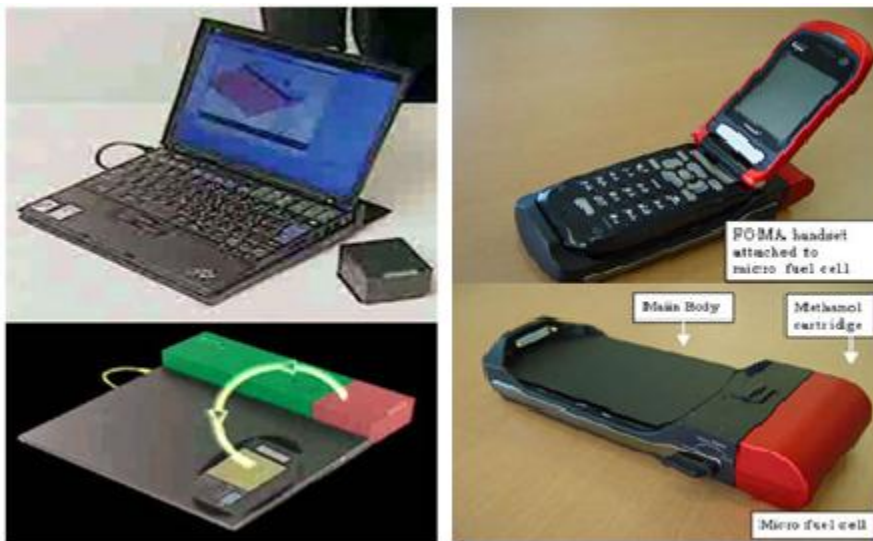
Figura 2.22 DMFC power pack num portátil (Sanyoand IBM).
