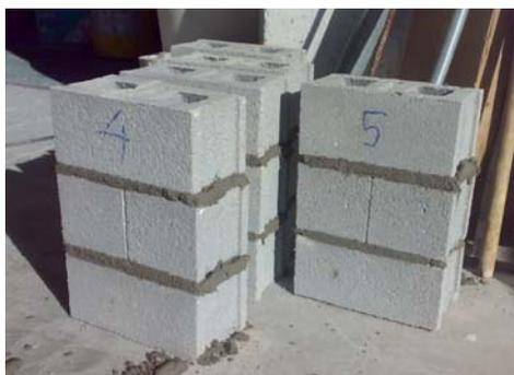
Figura 2.4 – Provetes para a caracterização da resistência à compressão da alvenaria.
