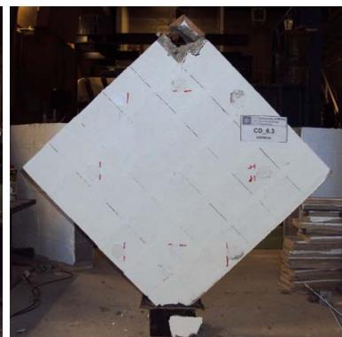
Figura 3.11 – Relação tensão de corte,  $\sigma_{xy}$ , e extensão ( $\epsilon_x$  e  $\epsilon_y$ ) e o modo de rotura resultante do ensaio de compressão diagonal dos provetes P6.
