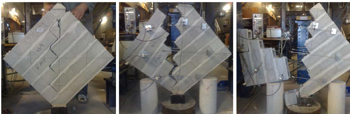
Figura 3.5 – Relação tensão de corte,  $\sigma_{xy}$ , e extensão ( $\epsilon_x$  e  $\epsilon_y$ ) e o modo de rotura resultante do ensaio de compressão diagonal dos provetes de alvenaria não armada.
