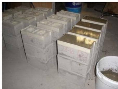
b) Colocação de argamassa auto-nivelante no topo dos provetes
