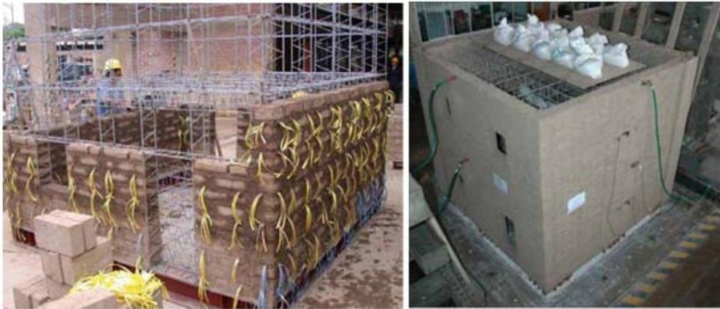
Figura 1.22 – Modelos com soluções inovadoras de alvenaria armada à escala reduzida em adobe (Adell, 2010).
