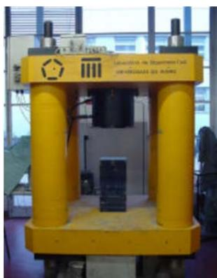
Figura 2.6 - Equipamento para ensaio de provetes de alvenaria à compressão.
