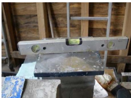
c) Colocação de lâmina de betume acrílico e o nível para verificação do nivelamento da chapa metálica
