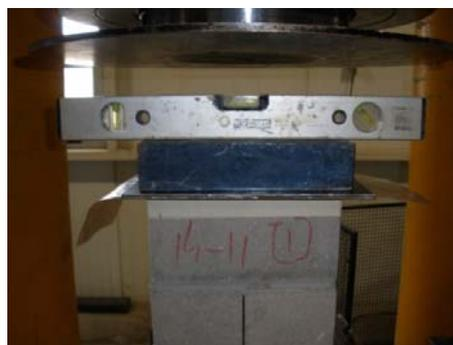
d) Nivelamento suplementar sobre o equipamento de ensaio
