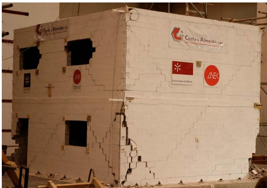
Figura 5.6 – Aspecto após a segunda fase com intensidade de 250% para o edifício de alvenaria não armada.
